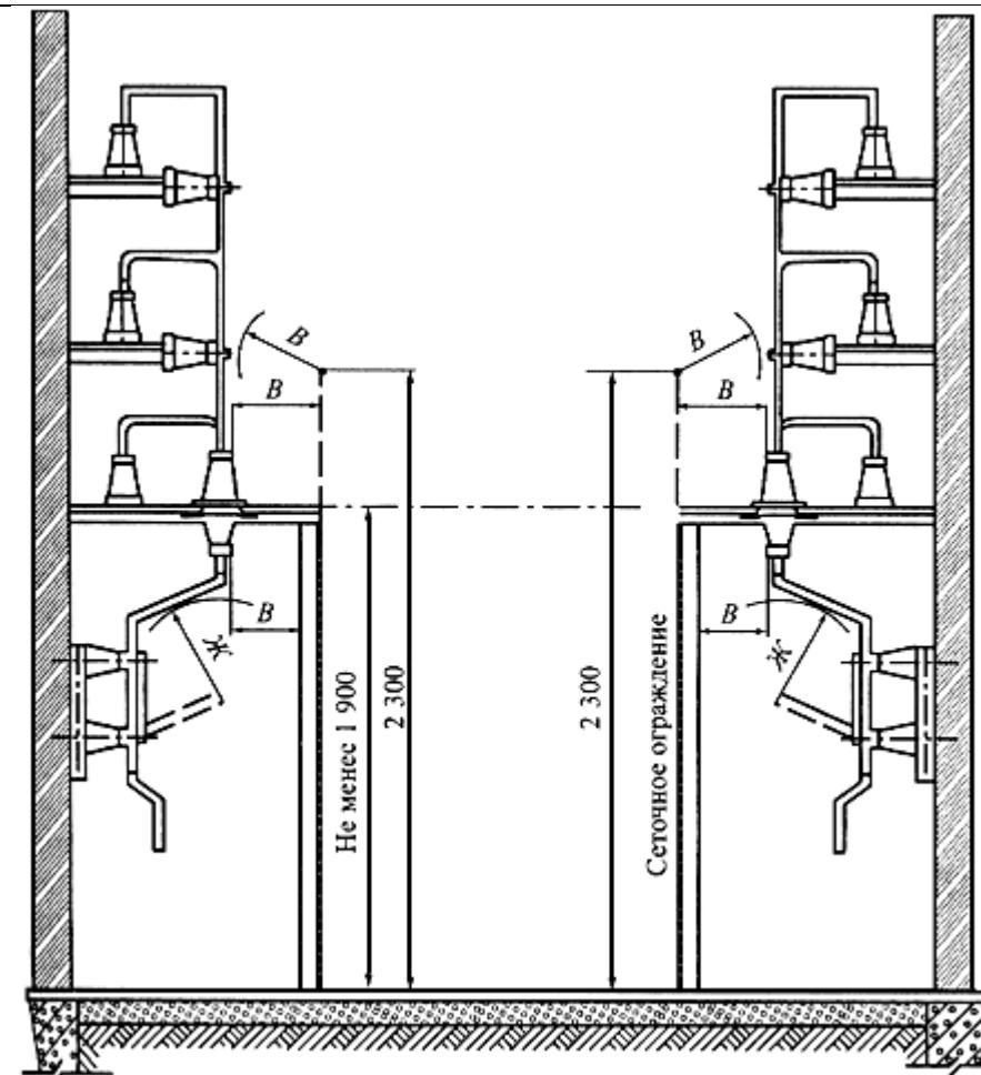
Рис.4.2.16. Наименьшие расстояния от неизолированных токоведущих частей в ЗРУ до сетчатых ограждений и между неогражденными неизолированными токоведущими частями разных цепей (по [табл.4.2.9](#))<sup>\*</sup>
