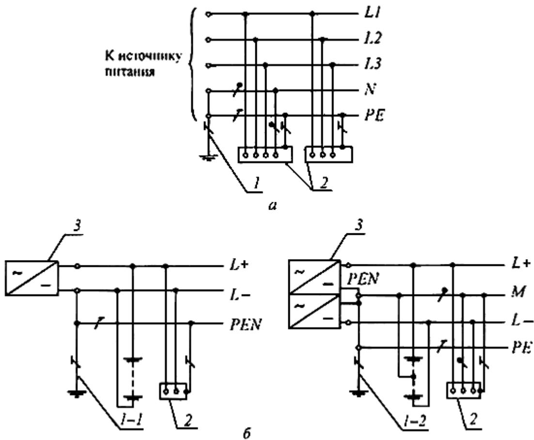
Рис.1.7.2. Система  $TN - S$  переменного ( $\alpha$ ) и постоянного ( $\beta$ ) тока. Нулевой защитный и нулевой рабочий проводники разделены:
