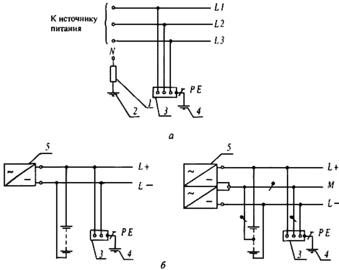
Рис.1.7.4. Система  $IT$  переменного ( $\alpha$ ) и постоянного ( $\beta$ ) тока.
