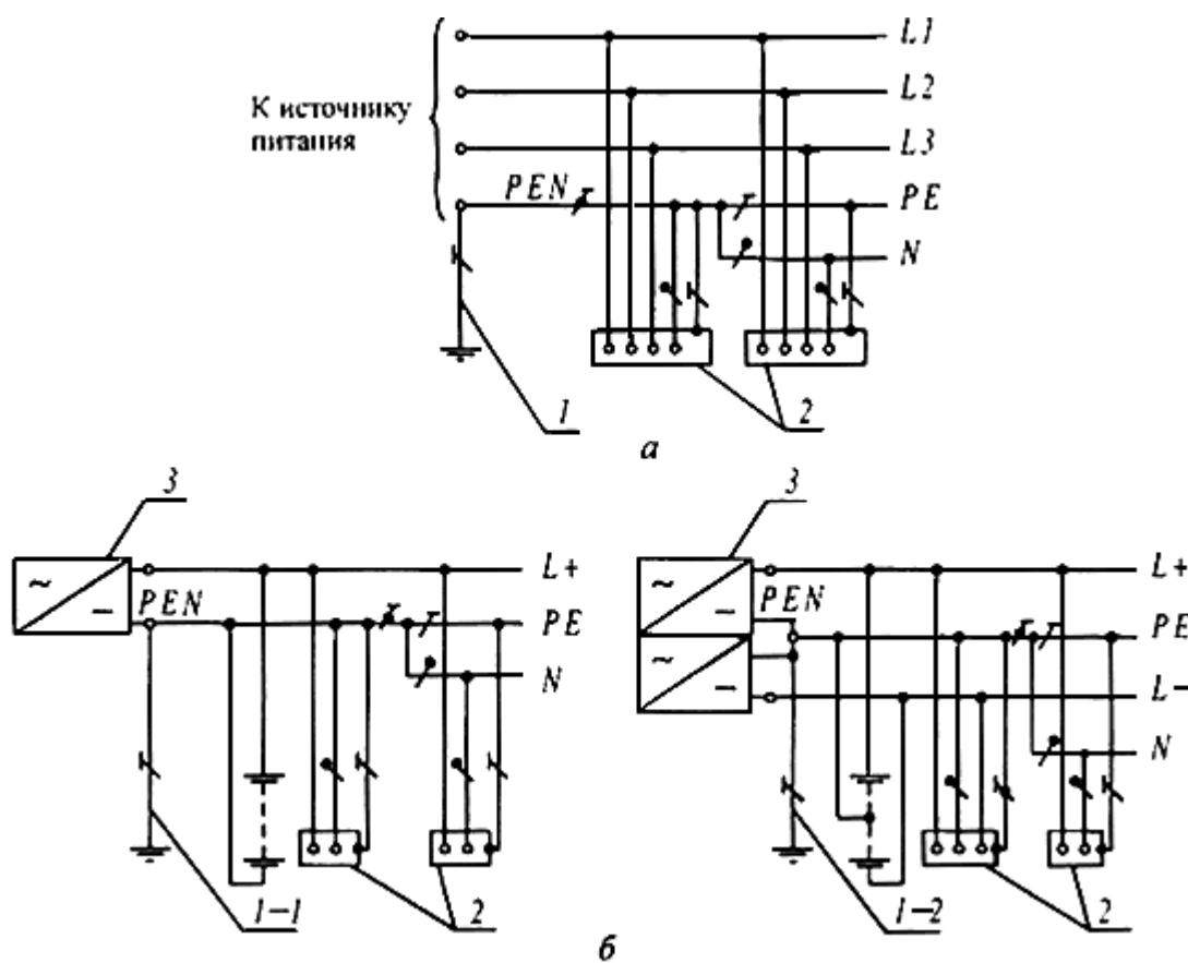
Рис.1.7.3. Система  $TN - C - S$  переменного ( $\alpha$ ) и постоянного ( $\beta$ ) тока.
