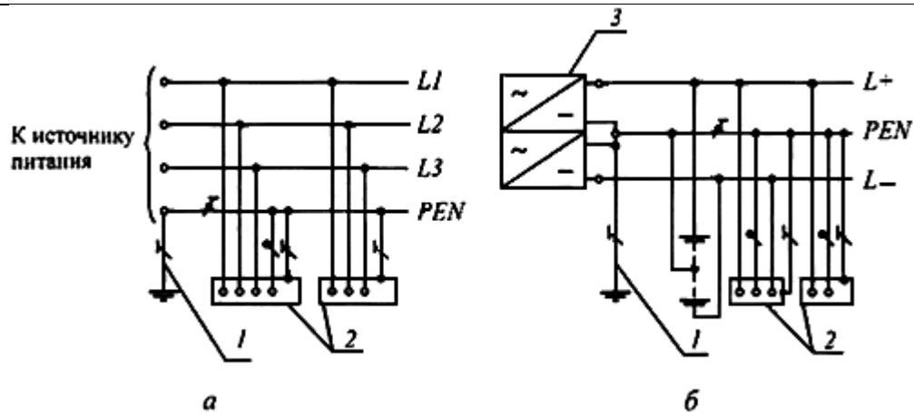
Рис.1.7.1. Система  $TN - C$  переменного ( $\alpha$ ) и постоянного ( $\beta$ ) тока. Нулевой защитный и нулевой рабочий проводники совмещены в одном проводнике: 1 - заземлитель нейтрали (средней точки) источника питания; 2 - открытые проводящие части; 3 - источник питания постоянного тока
