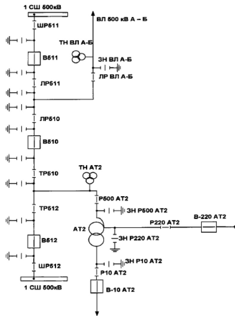
Рисунок 3. Схема ПС 500 кВ, выполненная по полуторной схеме
