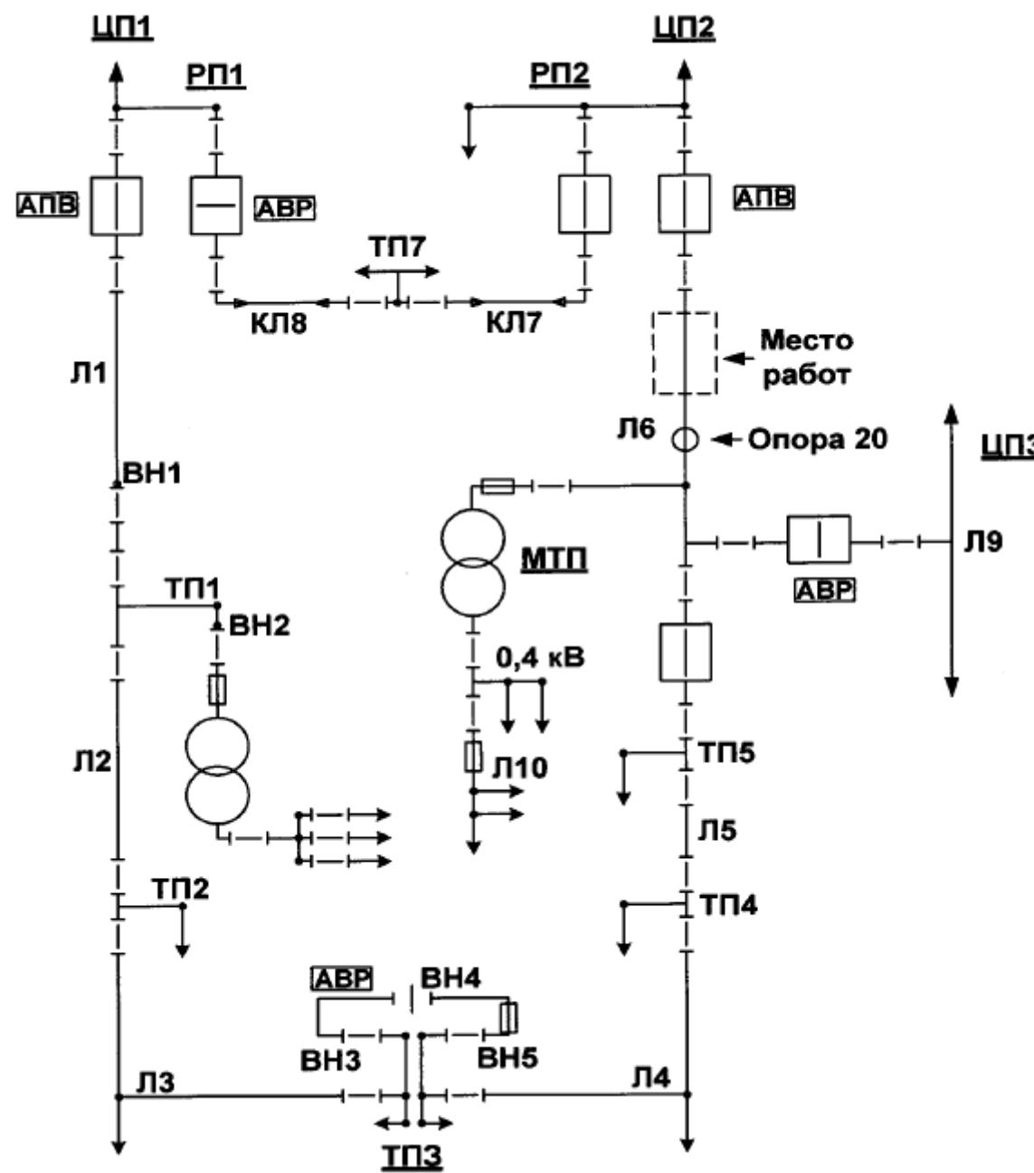
Рисунок 2. Схема участка распределительной электросети 6-10 кВ, секционированной в ТПЗ в нормальном режиме работы
