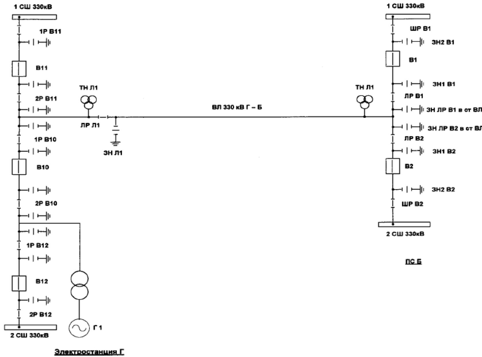
Рисунок 3. Схема подключения ВЛ 330 кВ Г-Б
