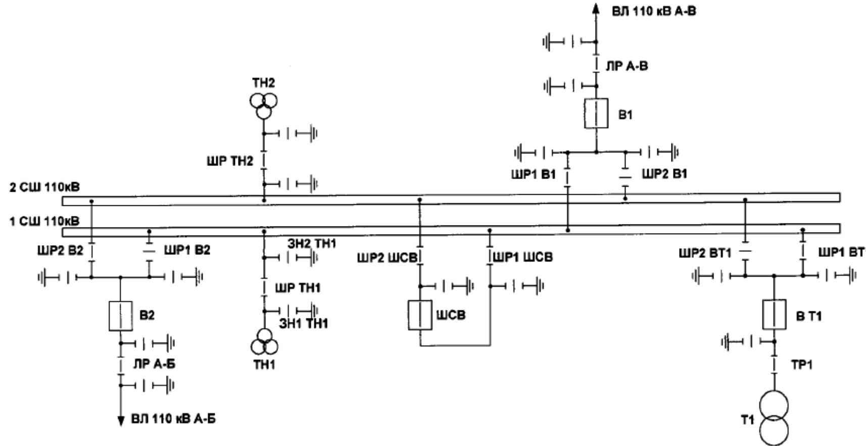
Рисунок 1. Схема РУ с двумя системами шин
