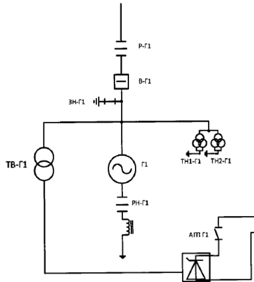
Рисунок 3. Ремонтная схема генератора Г1
