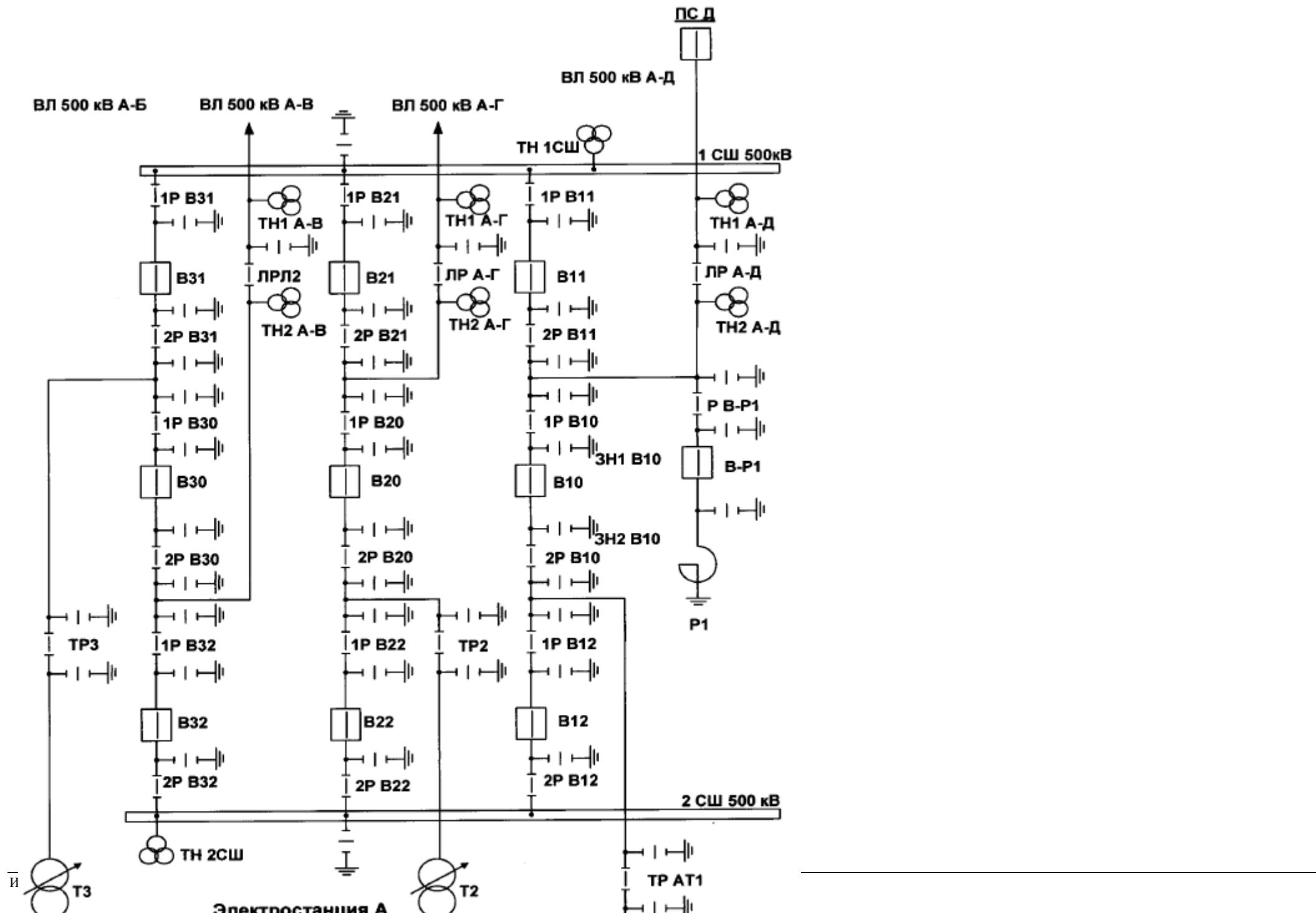
Рисунок 4. Полуторная схема РУ
