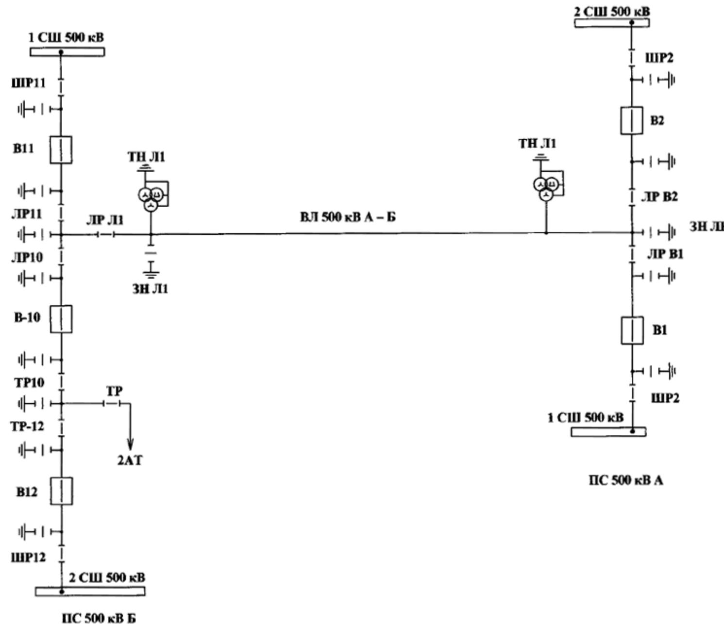
Рисунок 1. Схема подключения ЛЭП 500 кВ А-Б
