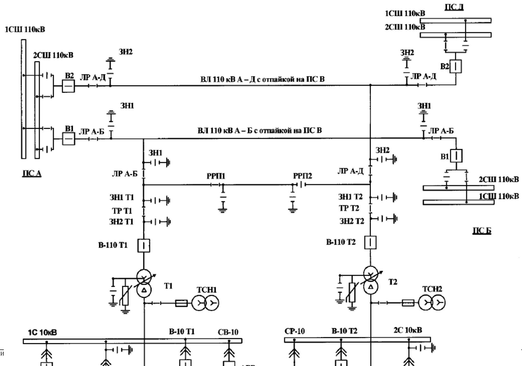
Рисунок 1. Схема сети напряжением 110 кВ с отпаечной двухтрансформаторной подстанцией, питающейся от двух транзитных линий электропередачи
