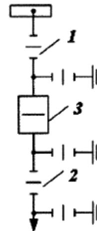
1 - шинный разъединитель; 2 - линейный разъединитель; 3 - выключатель
