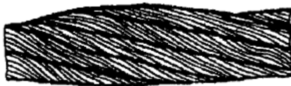
Рисунок 13. Местное увеличение диаметра каната.
