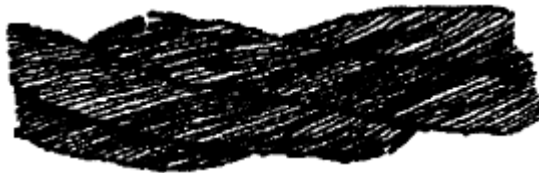
Рисунок 1. Обрывы и смещения проволок каната крестовой свивки.
